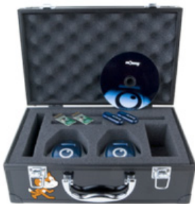
Fig. 1 – a sinistra l’edizione “mOway Scratch Kit” con 2 mOway completi di interfaccia Wi-Fi per operare con Scratch – a destra il robot mOway
