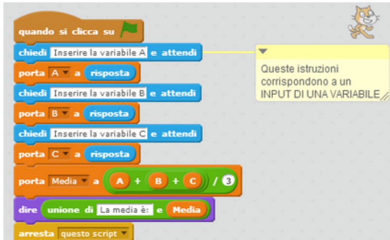
Figura 1 – Lo script per il calcolo della media di 3 numeri in input.
