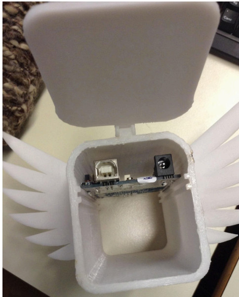
Figura 6 - Il bidoncino con Arduino per la mobilità del coperchio
