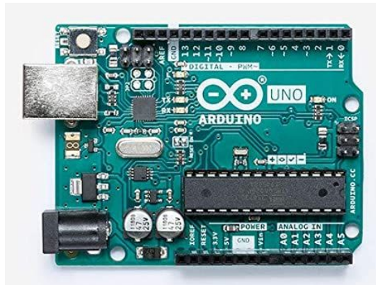
Figura 4 - La scheda di prototipazione Arduino UNO R3.
