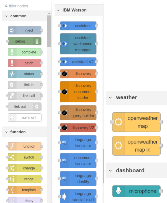
Figura 7 - La Palette dei nodi generali di NODE RED; Figura 8 - La Palette dei nodi specifici per IBM Watson; Figura 9 - La Palette dei nodi specifici per Open Weather Map
