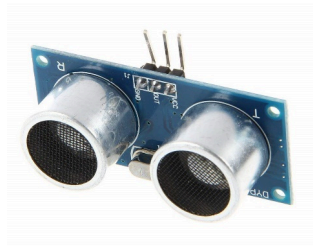
Figura 6 - Sensore di distanza/prossimità ad ultrasuoni
