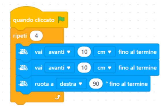
Figura 5 - Codice a blocchi con il ripeti per far realizzare il quadrato
