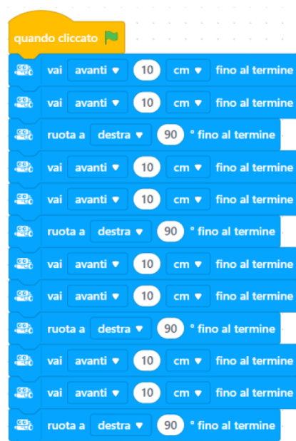
Figura 3 - Codice a blocchi per far percorrere il quadrato al robot
