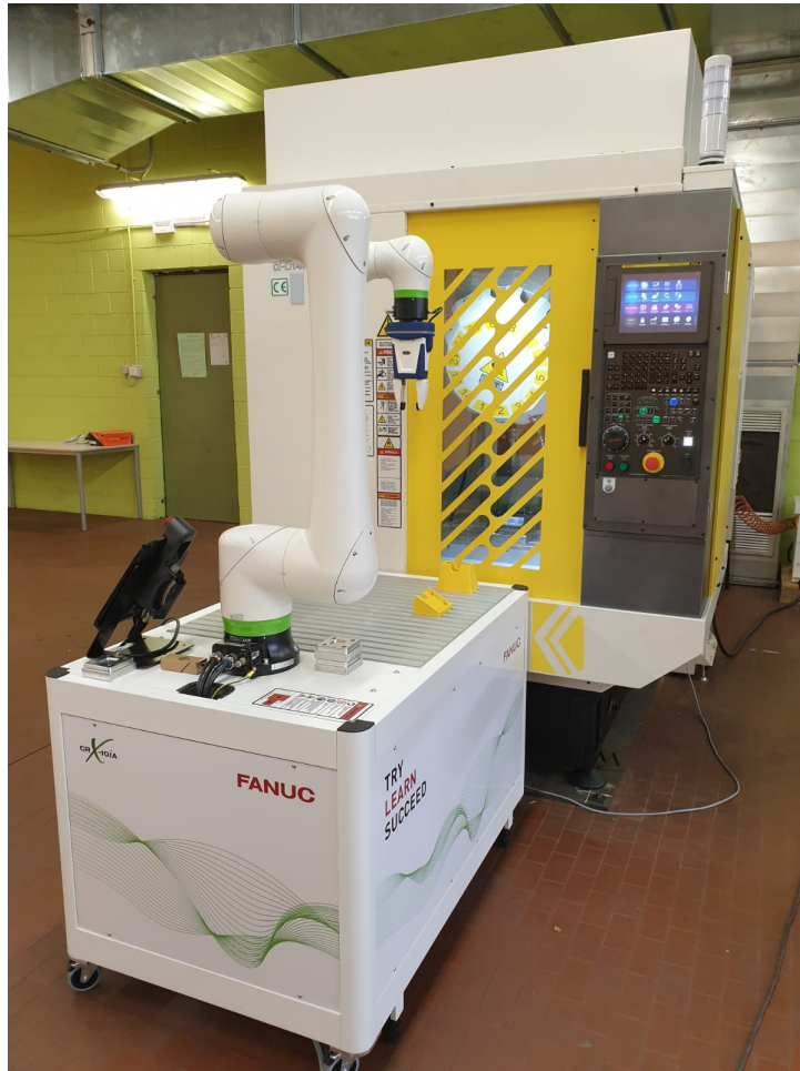
Figura 1 - Fresatrice CNC Robodrill e il robot antropomorfo
