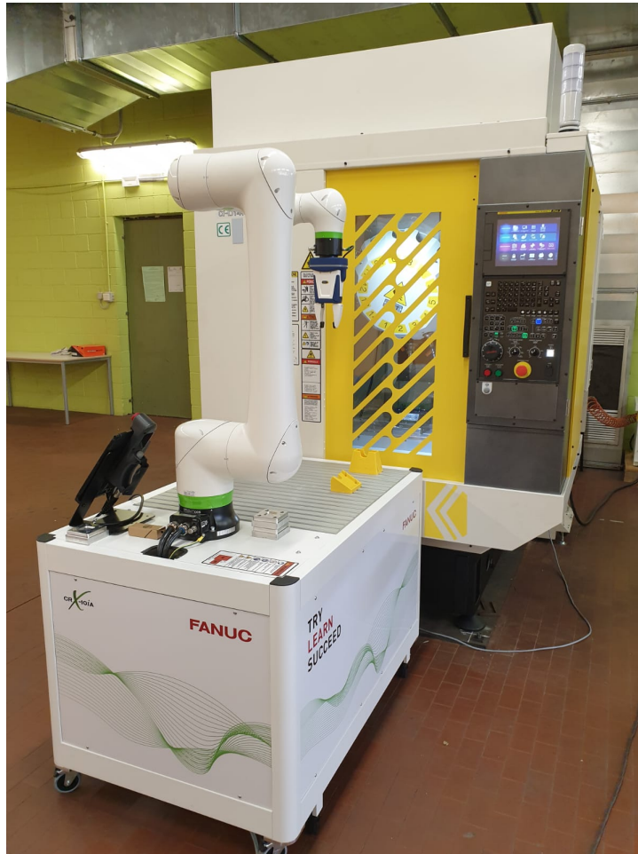
Figura 1 - Fresatrice CNC Robodrill e il robot antropomorfo
